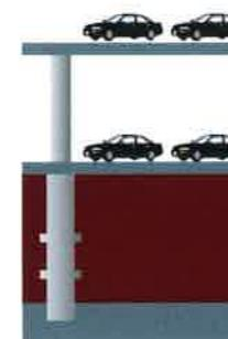
ノンフーチング工法のメリットは杭の上に直接構造体の柱を乗せることが出来るので、基礎ベースを必要とせず、掘削・鉄筋・基礎型枠を施工しないで施工できる為工期の短縮、資材の節約、工数削減が見込まれ大幅なコスト削減に繋げることが出来ます。
