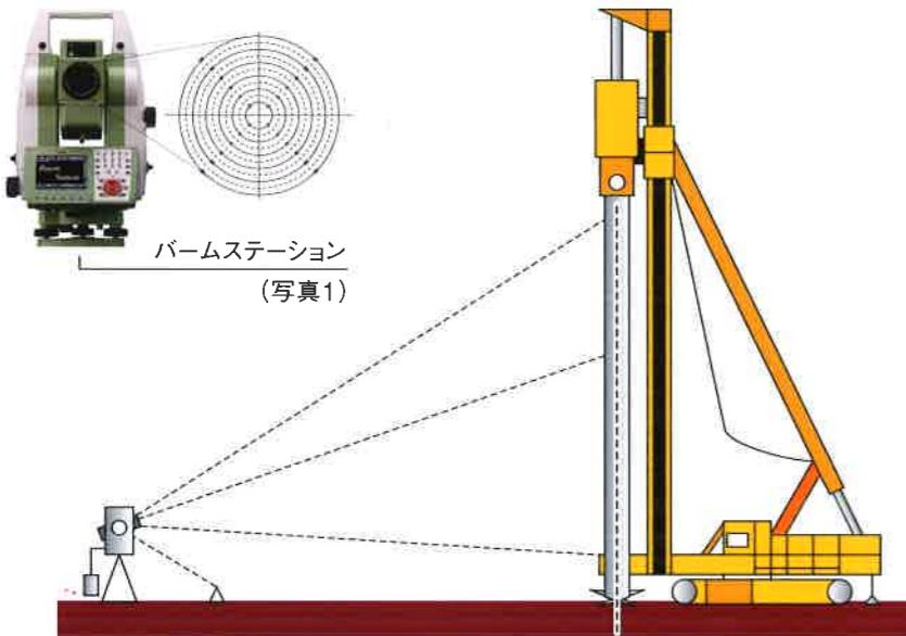
測量器を従来の照準用線が十字線のトランシットから、同心円状のレチクルを搭載した、バームステーション(写真1)に替えることにより、杭打設時のロッド中心軸座標を1台で、偏心・傾斜を一度に測定できる為、基準点の減少や2方向からの視准が不要になり、施工精度の向上と作業の効率化が図れる工法です。バームステーション(レクチル)とは対象物の両端からの離れ量を左右同じになるようにセットする事で、対象物にマーキングすることなく対象物の芯を照準し、ターゲットプリズムを必要とせずに光波測量を行うことができます。これにより、稼動している重機ロッドの回転を止めることなく傾斜・水平偏心を正規の杭芯から測定でき、また座標管理している為数値で管理できる工法です。
