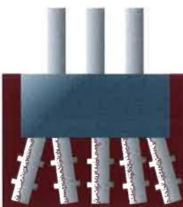
基礎工事を施工するにあたり、従来の杭打設工法では掘削後に杭頭の偏心を計測しています。それでは地中にある杭の偏心・傾斜が確認出来ず、杭本来の支持力を發揮出来ているか明確ではありません。建物の構造・デザインが進化していく中で、杭の精度管理が現状のままいいのかという考えに至りました。
