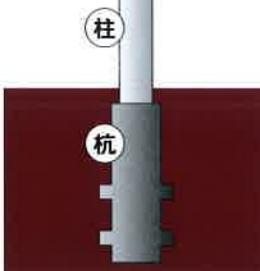
ノンフーチング工法とは地中梁を無くし、杭の上に直接柱を乗せる為杭の打設精度がとても重要であり、また杭が管理値を超えた場合、打ち直しのリスクなどがある為、現場での実現が難しい状況でした。
