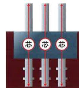
杭打設工法において、パイリングメジャーメント工法を導入し、杭打設中に相伴測量をし、杭の精度向上を目指します。杭の精度の向上により、杭本来の支持力を発揮出来ます。杭本来の支持力を保つことで耐久性に優れた、安心出来る建設工事に役立てる事が出来ます。
